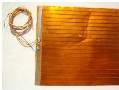
**Figura 1-Aleta plana retangular** **Figura 2-Fonte de calor (resistência de KANTAL)**
